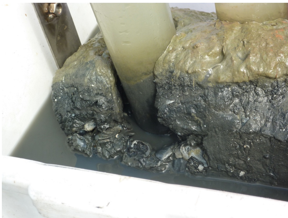
Figuur 7-2: Bodemonster ter hoogte van slibvangeel, van boven naar beneden: sliblaag, holoceen klei, oude Zuiderzeelaag met schelpenbank (foto: E. Ebbens, 4 juni 2013).
