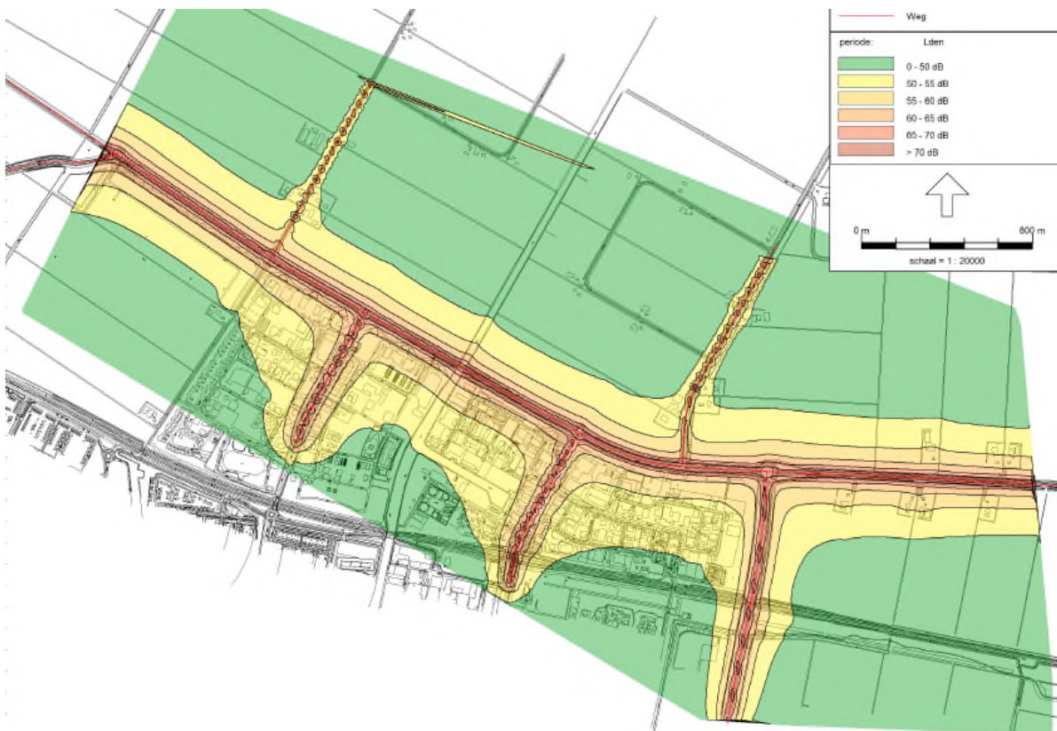
figuur 5.2: Geluidcontouren in autonome situatie (2025)
