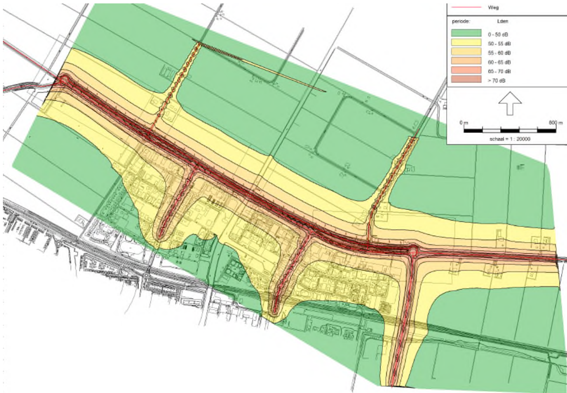
figuur 5.3: Geluidcontouren plansituatie (met realisatie Passage Dronten, 2025).
