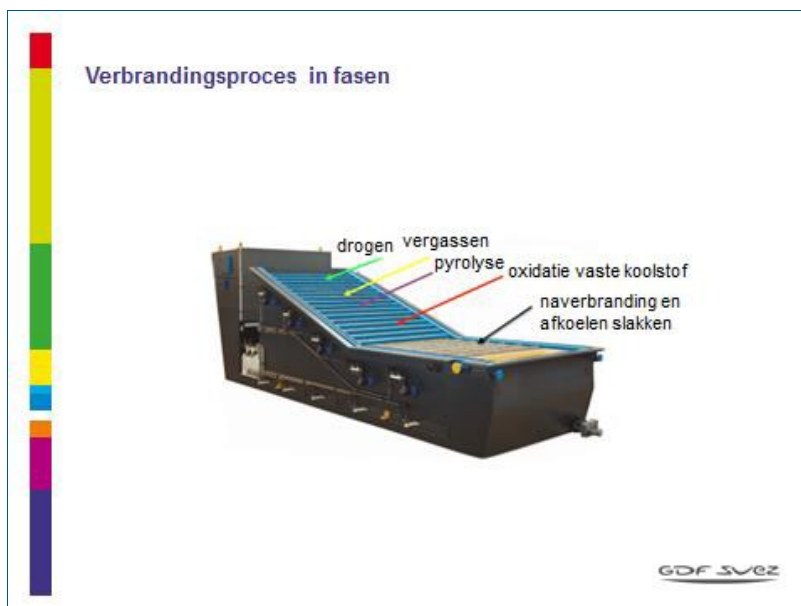
Figuur 4.4: Weergave procesfasering van roosterketel
