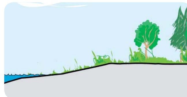
Kleine plas met talud rond oeverlijn van 1: 10 en een bovenwartertalud van 1 : 6, mantelzoomzone van 10 - 40 meter
