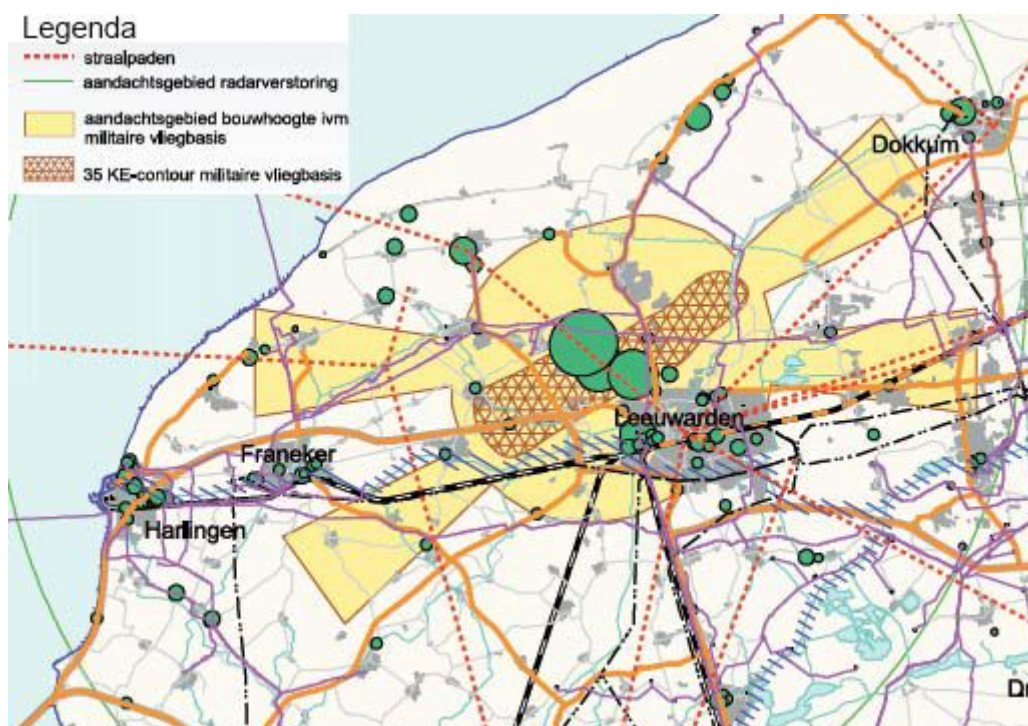
figuur: zones bouwhoogtebeperking en straalpaden
