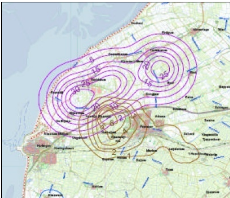
Figuur 13. Bodemdaling door gas- en zoutwinning
