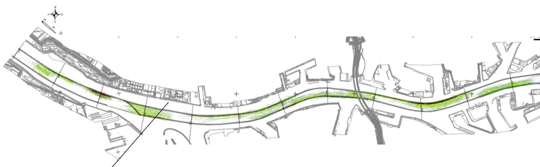
Figuur 2.10 Baggertracks uit het jaar 2010 tussen km 1006 -1017. Bron: RWS Noordzee.
