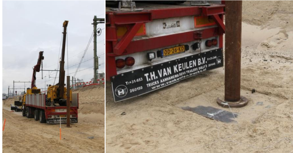
Figuur III-2 Opstelling valgewicht (links) en voetplaat en geleidingsbuis (rechts)
