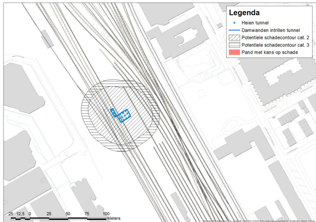
Figuur 9-5 Schadecontouren bij opstelsterrein zuidzijde Utrecht Centraal (heien machinistentunnel en intrillen damwanden machinistentunnel)
