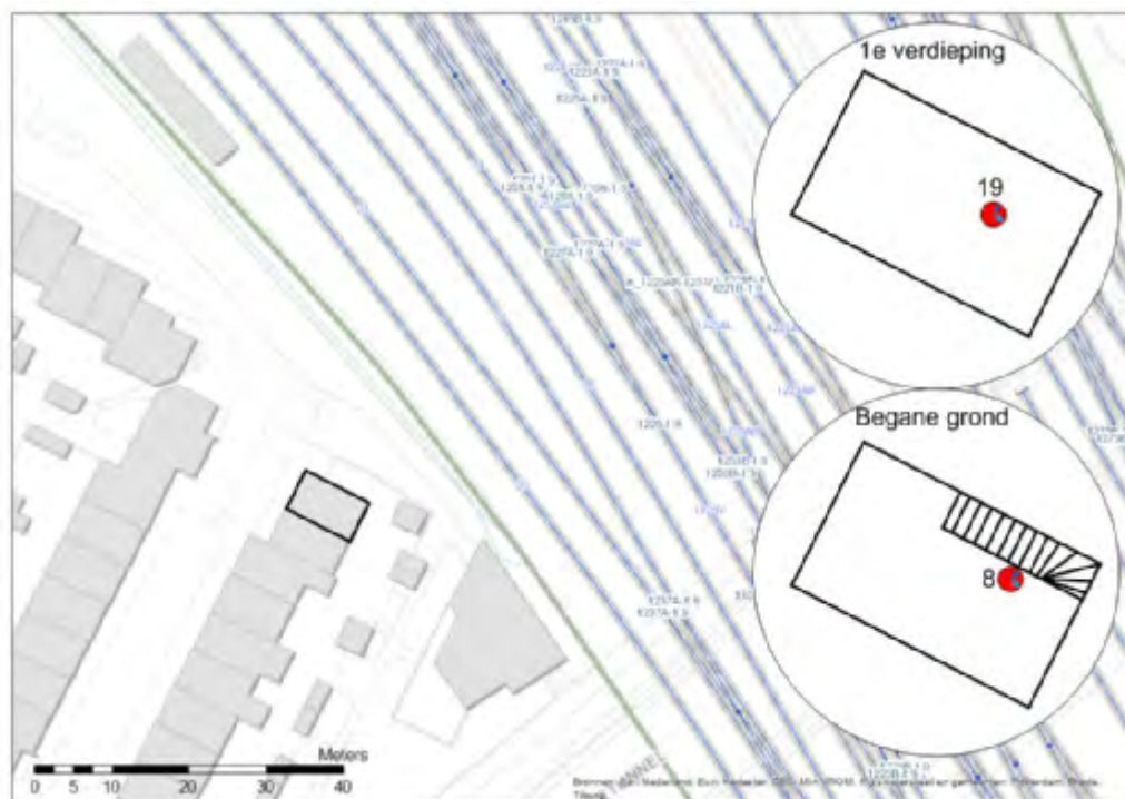
Figuur III - 11 Opstelling sensoren bij J.J.A. Goeverneurstraat 47
