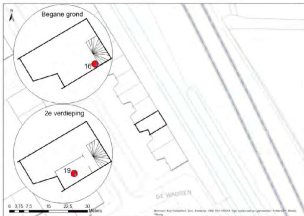
Figuur III - 80 Opstelling sensoren bij Engelsmanstraat 48
