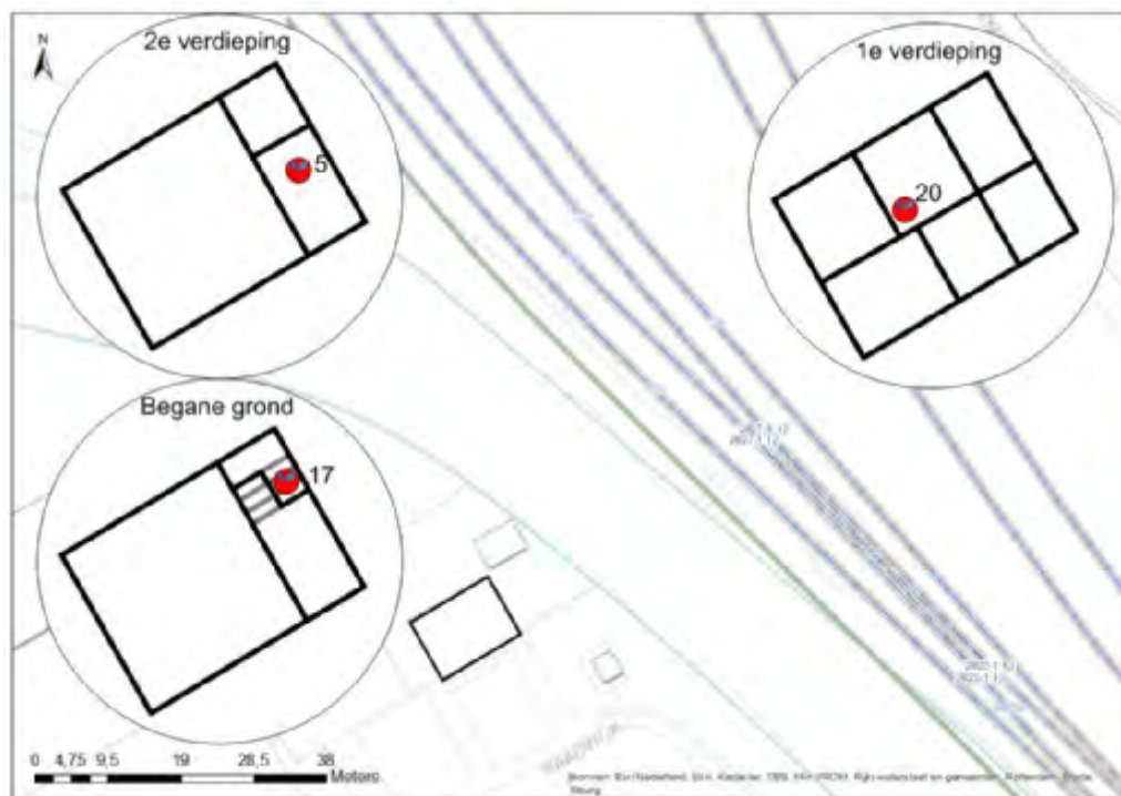
Figuur III - 33 Opstelling sensoren bij Hendrik Tollenstraat 1 en 5
