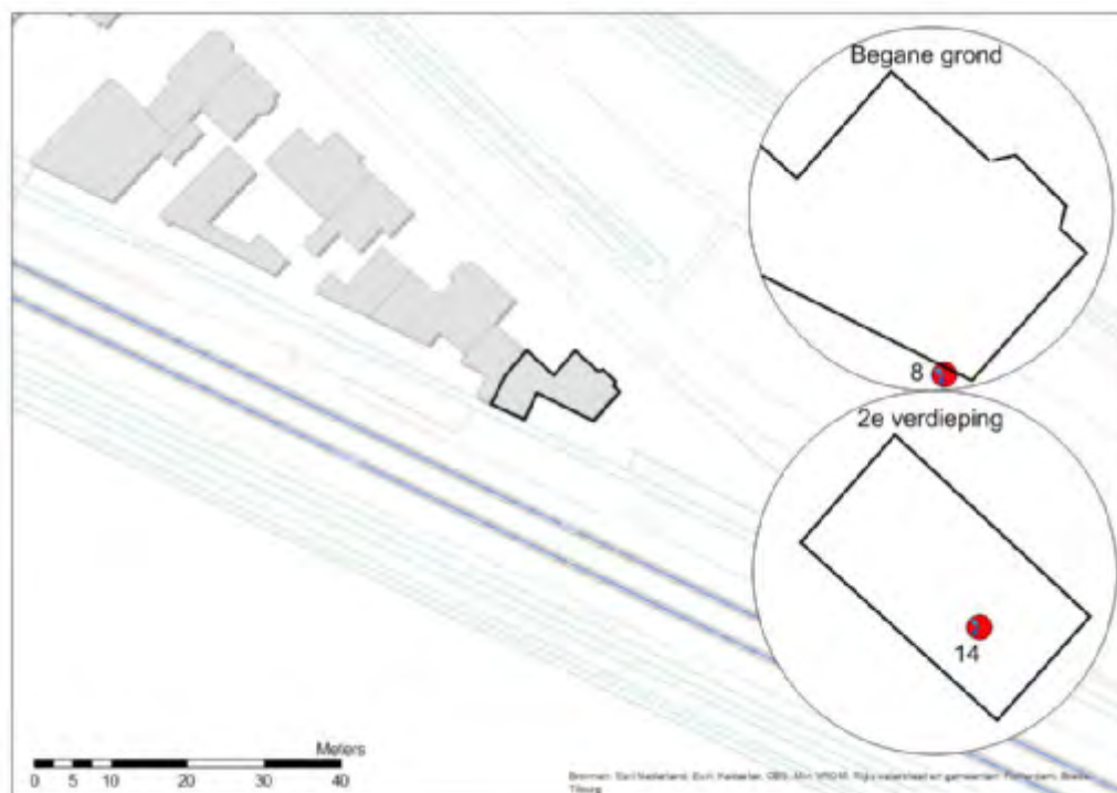
Figuur III - 119 Opstelling sensoren bij Koningsweg 187
