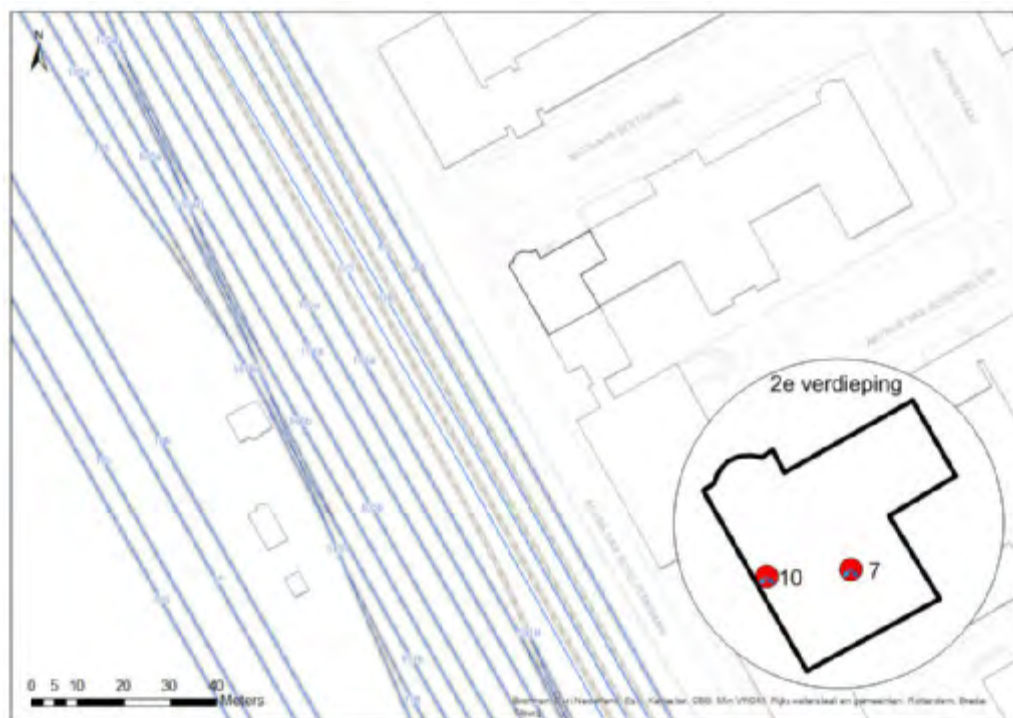
Figuur III - 178 Opstelling sensoren bij Nicolaas Beetsstraat 222
