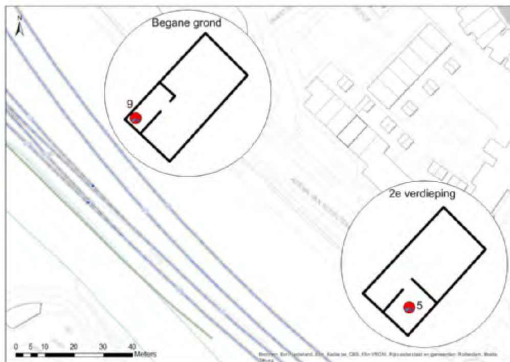
Figuur III - 156 Opstelling sensoren bij Vaartsestraat 176
