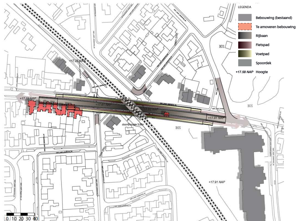
Figuur 17: Plattegrond onderdoorgang Bornebroeksestraat
