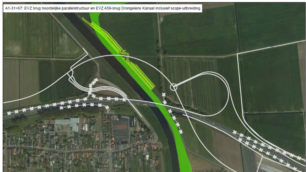
Figuur 15: EVZ brug noordelijke parallelstructuur en EVZ A59-brug Drongelens Kanaal; aanleg Ecologische Verbindings Zone [ EVZ ] (groene strook); De witte lijn is een andere GOL-maatregel.
