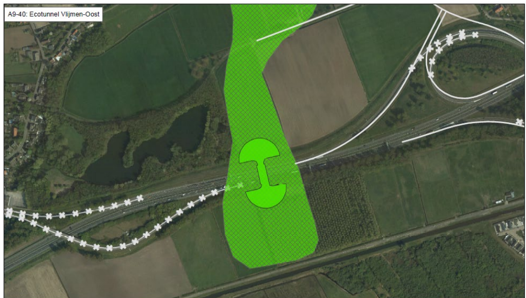
Figuur 19: Ecotunnel Vlijmen-Oost: aanleg Ecotunnel onder A59 (groen haltervormig gebied). De witte lijn is een andere GOL-maatregel. Groen geblokte deel is deel van de EVZ dat niet binnen het programma GOL valt.
