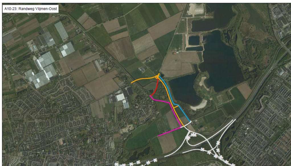
Figuur 14: Randweg Vlijmen: verbeteren / (ver)nieuwen secundaire weg (oranje lijn); verbeteren / vernieuwen fietspad (gele lijn); aanleg fietsstraat (blauwe lijn); aanleg eerste type combiweg [ fiets, OV] (rode lijn) en tweede type combiweg: landbouw en fiets (paars) De witte lijn is een andere GOL-maatregel.
