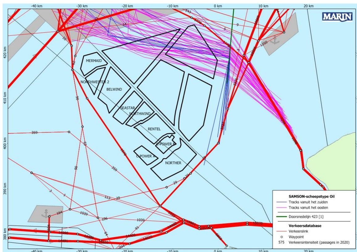
Figuur 7 Tracks van Olieschepen rondom Borssele behorend bij de passages van doorsnedelij 423 in westelijke richting in de periode augustus 2013 t/m juli 2014 [1]
