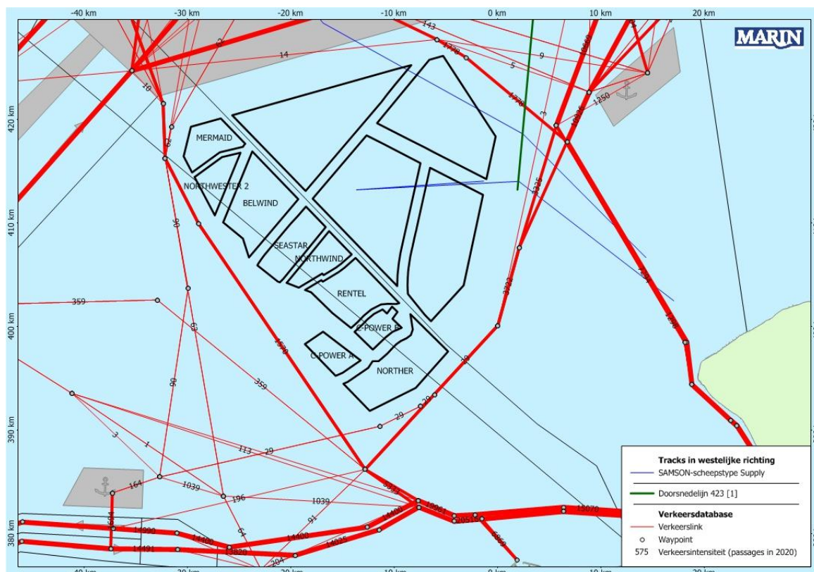
Figuur 12 Tracks van bevoorradingsschepen rondom Borssele behorend bij de passages van doorsnedelij 423 in westelijke richting in de periode augustus 2013 t/m juli 2014 [1]
