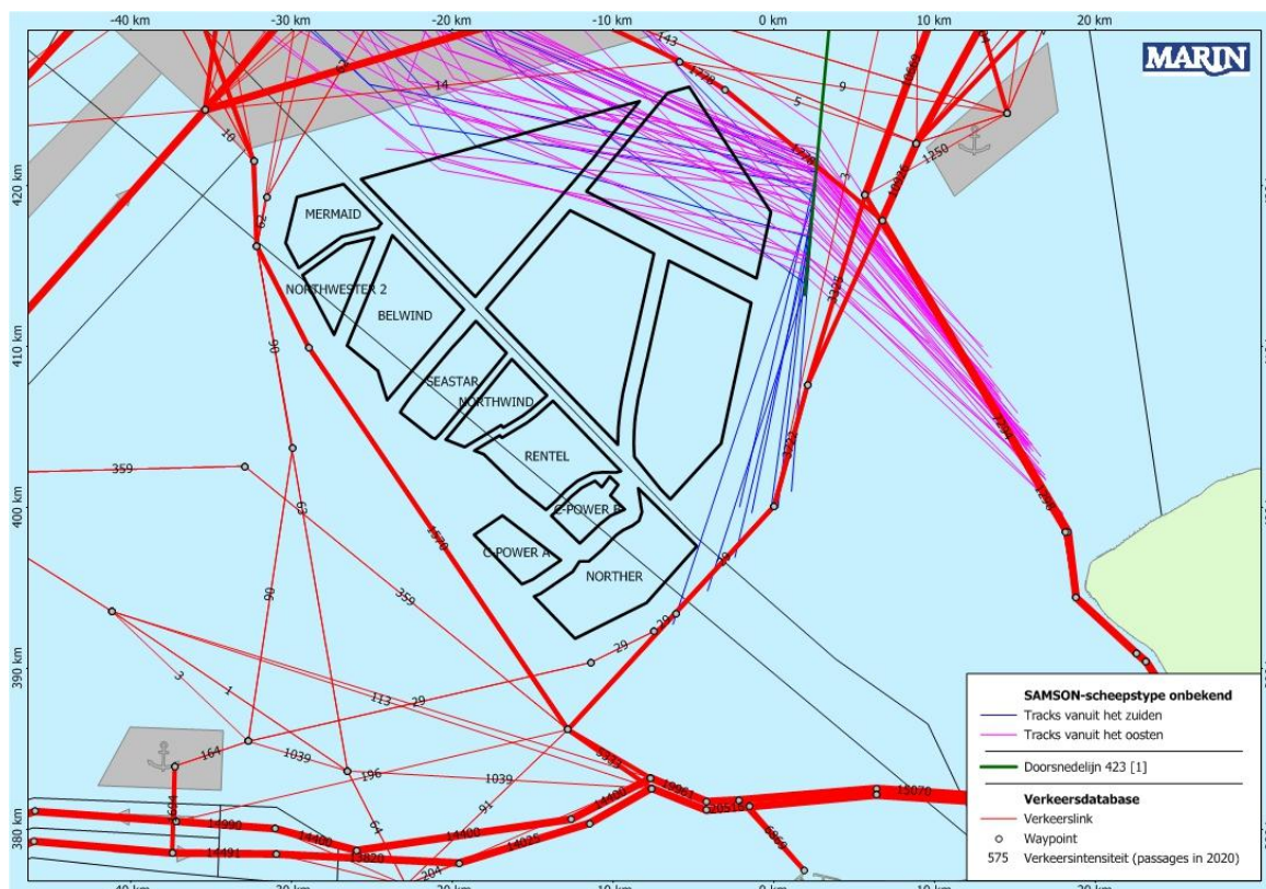
Figuur 8 Tracks van schepen (type onbekend) rondom Borssele behorend bij de passages van doorsnedelij 423 in westelijke richting in de periode augustus 2013 t/m juli 2014 [1]
