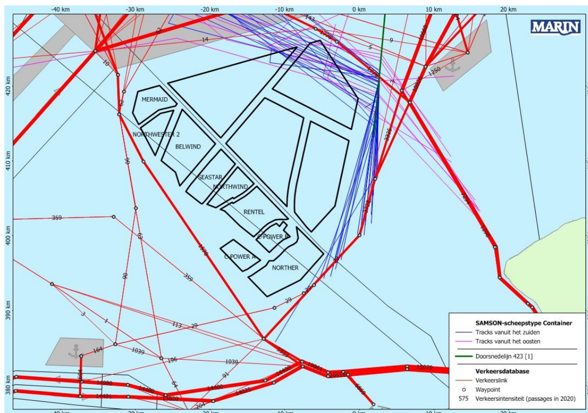
Figuur 4 Tracks van containerschepen rondom Borssele behorend bij de passages van doorsnedelij 423 in westelijke richting in de periode augustus 2013 t/m juli 2014 [1]
