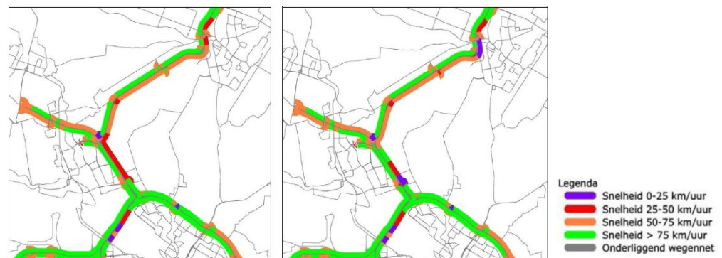
Figuur 7.2: Rijksnelheden in de situatie 2030 zonder (links) en met het project (rechts), avondspits (bron: NRM 2013 WEST)
