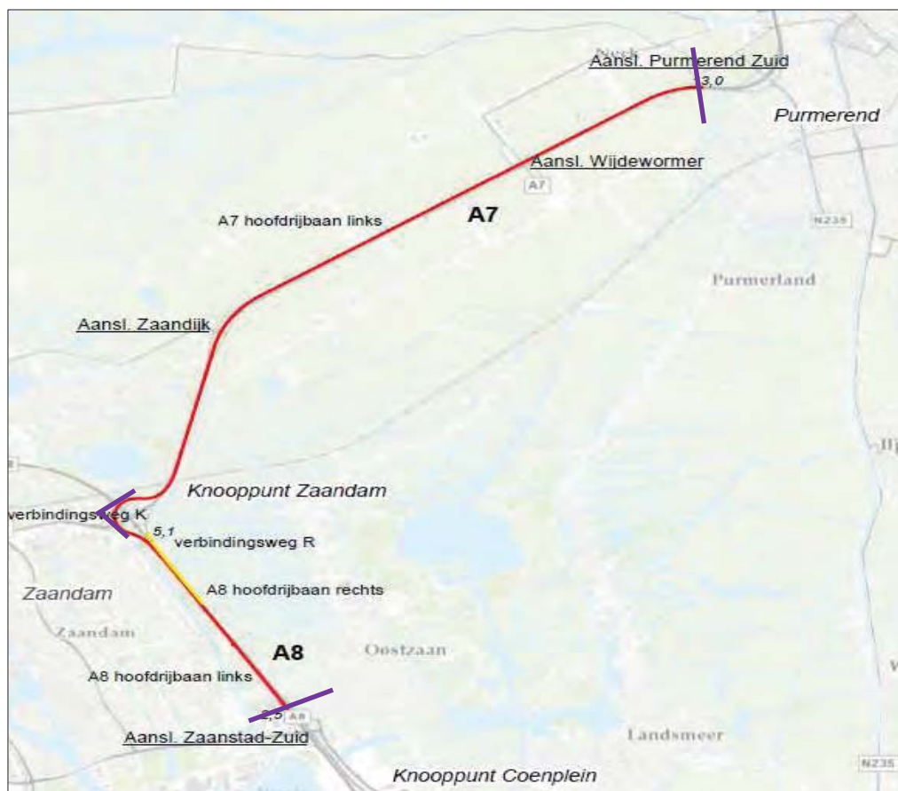
Figuur 4: De brongegevens wijzigen alleen binnen de projectgrenzen, buiten dit gebied wijzigen de brongegevens niet en zijn deze ontleend aan het geluidregister, de paarse lijnen geven de projectgrenzen van het gebied aan. De rode en gele lijn geven de te wijzigen wegvakken aan.
