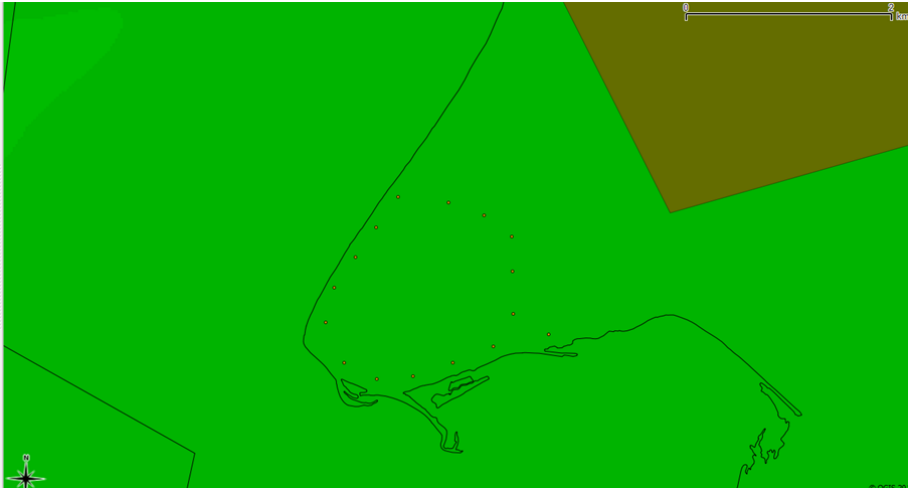
Figuur 23 De gecombineerde detectiekans van de TAR4 en het MASS primaire verkeersleidingsradarnetwerk op 1000 voet boven en in de nabijheid van het bouwplan nadat Variant 'Klein' is gerealiseerd. De minimale detectiekans boven het windpark bedraagt ca. 100%. Detectiekansmiddeling is toegepast.
