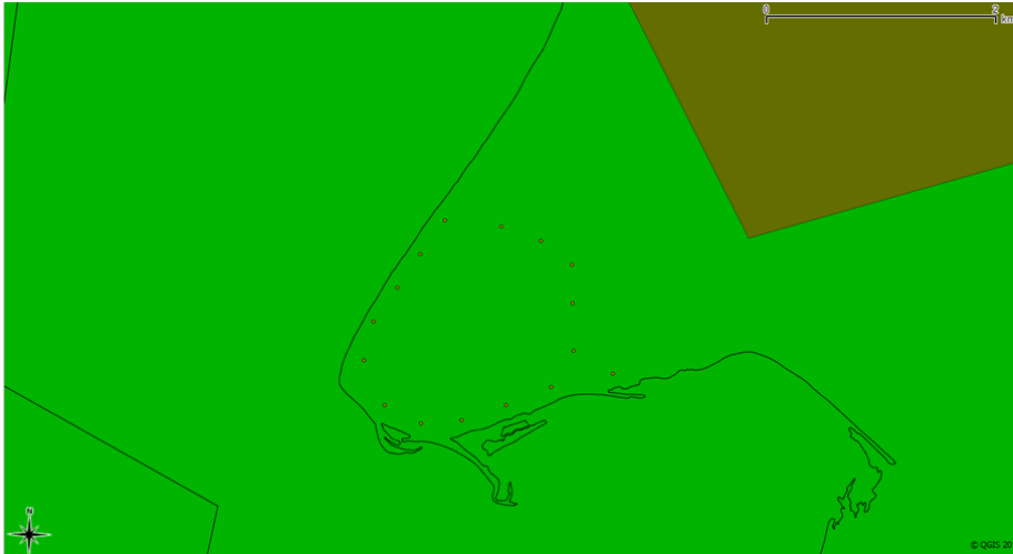
Figuur 25 De gecombineerde detectiekans van de TAR4 en het MASS primaire verkeersleidingsradarnetwerk op 2000 voet boven en in de nabijheid van het bouwplan nadat Variant 'Klein' is gerealiseerd. De minimale detectiekans boven het windpark bedraagt ca. 100%. Detectiekansmiddeling is toegepast.
