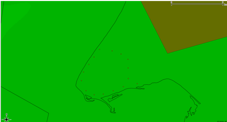
Figuur 22 De detectiekans van de TAR4 op 1000 voet boven en in de nabijheid van het bouwplan na verwijdering van de 32 bestaande windturbines en realisatie van het windpark variant 'Klein'. De stippen geven de locaties aan van de nieuwe windturbines. Detectiekansmiddeling is toegepast.
