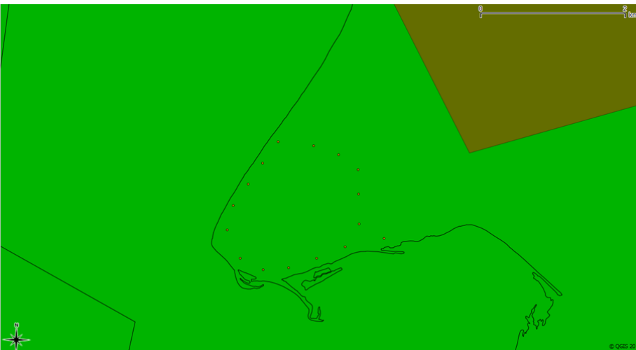
Figuur 24 De gecombineerde detectiekans van de TAR4 en het MASS primaire verkeersleidingsradarnetwerk op 1500 voet boven en in de nabijheid van het bouwplan nadat Variant 'Klein' is gerealiseerd. De minimale detectiekans boven het windpark bedraagt ca. 100%. Detectiekansmiddeling is toegepast.
