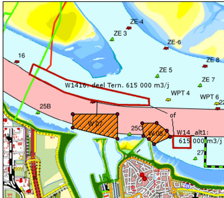
Figuur 11-8 Voorgestelde stortvakken (W07, W08 en W1416 of W14_alt1) met bijbehorende hoeveelheden. Figuur aangepast van Rijkswaterstaat (2011). Volumes uit Arcadis (2013). Volumes van W07 en W08 blijven gelijk ten opzichte van Figuur 11-7
