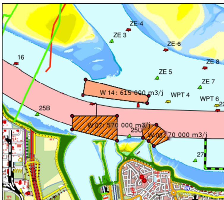
Figuur 11-7 Huidige stortvakken (W07, W08 en W14) met gegunde hoeveelheden. Figuur aangepast van Rijkswaterstaat (2011). Volumes uit Arcadis (2013)
