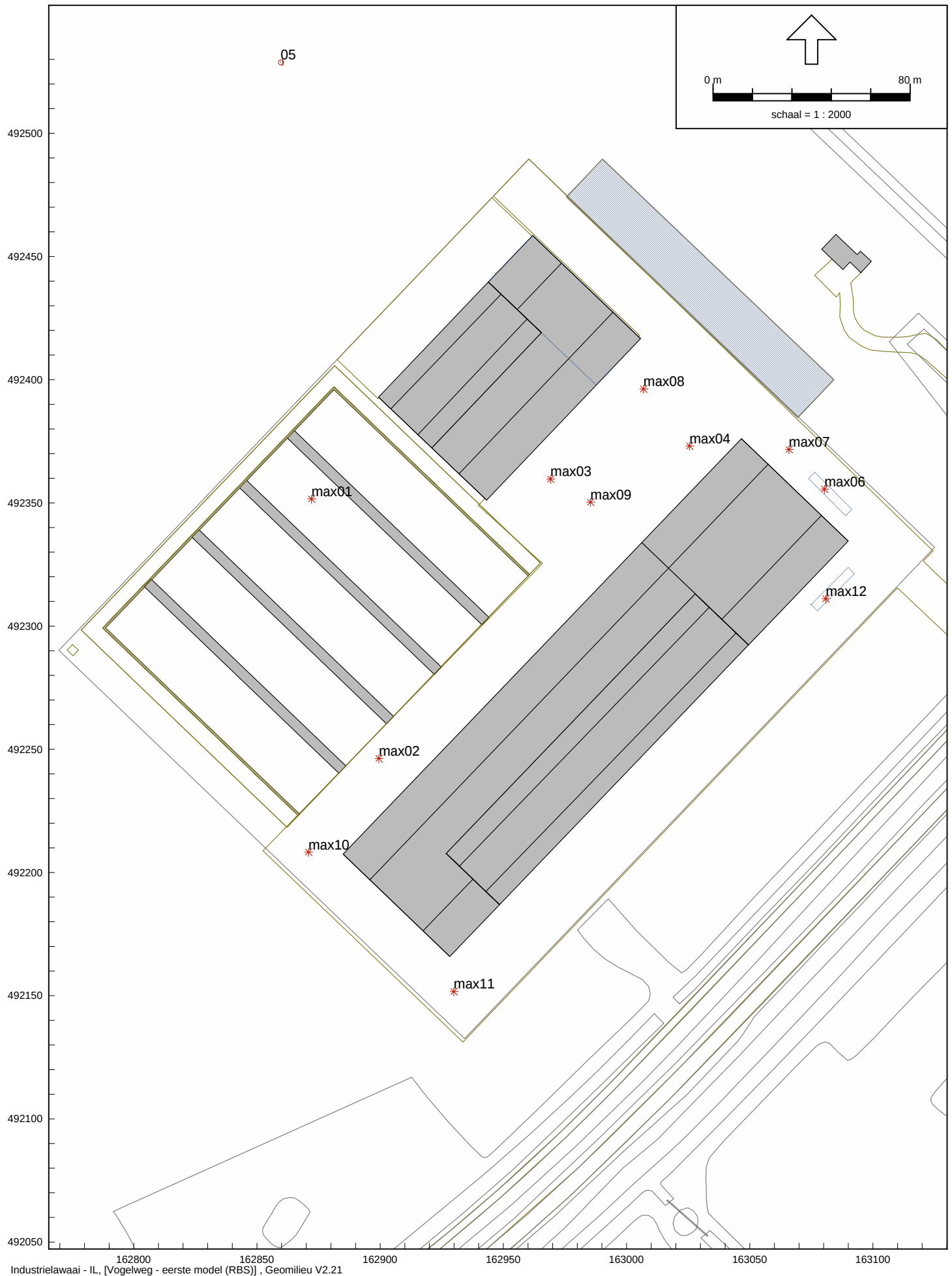
Overzicht van het rekenmodel met de ligging van de piekgeluidsbronnen
