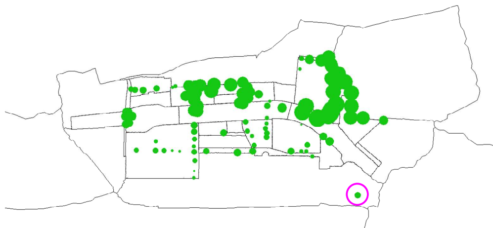
Figuur 21: resultaat gevoeligheidsanalyse c-waarde 200 %. Een blauwe stip geeft een grondwaterstand weer die lager ligt dan de geijkte grondwaterstand, een groene stip een grondwaterstand die hoger ligt dan de geijkte grondwaterstand. Rechtsonder is een groene stip in een paarse cirkel te zien. De doorsnede van deze groene stip geeft een afwijking van 20 cm weer.
