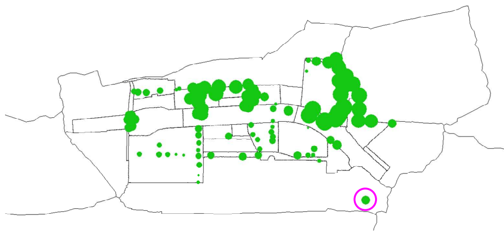
Figuur 20: resultaat gevoeligheidsanalyse c-waarde 150 %. Een blauwe stip geeft een grondwaterstand weer die lager ligt dan de geijkte grondwaterstand, een groene stip een grondwaterstand die hoger ligt dan de geijkte grondwaterstand. Rechtsonder is een groene stip in een paarse cirkel te zien. De doorsnede van deze groene stip geeft een afwijking van 20 cm weer.
