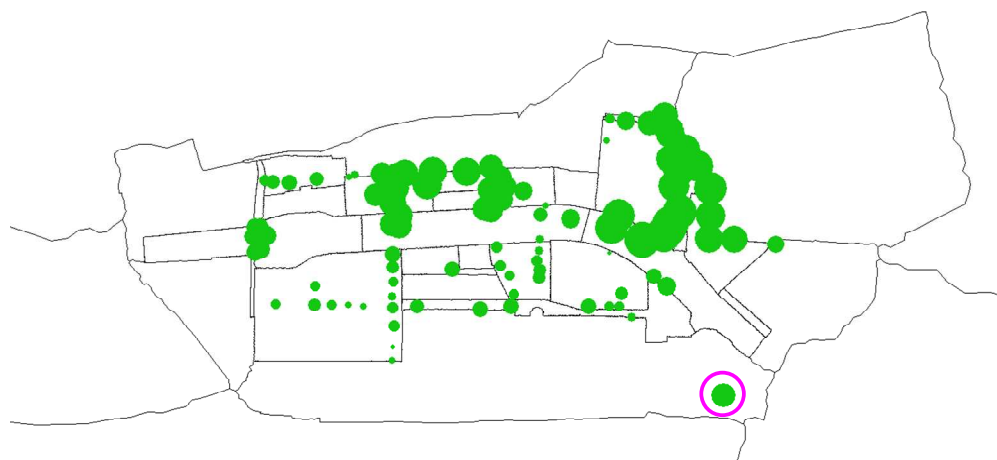
Figuur 19: resultaat gevoeligheidsanalyse c-waarde 120 %. Een blauwe stip geeft een grondwaterstand weer die lager ligt dan de geijkte grondwaterstand, een groene stip een grondwaterstand die hoger ligt dan de geijkte grondwaterstand. Rechtsonder is een groene stip in een paarse cirkel te zien. De doorsnede van deze groene stip geeft een afwijking van 20 cm weer.
