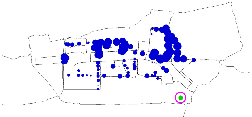
Figuur 18: resultaat gevoeligheidsanalyse c-waarde 70 %. Een blauwe stip geeft een grondwaterstand weer die lager ligt dan de geijkte grondwaterstand, een groene stip een grondwaterstand die hoger ligt dan de geijkte grondwaterstand. Rechtsonder is een groene stip in een paarse cirkel te zien. De doorsnede van deze groene stip geeft een afwijking van 20 cm weer.
