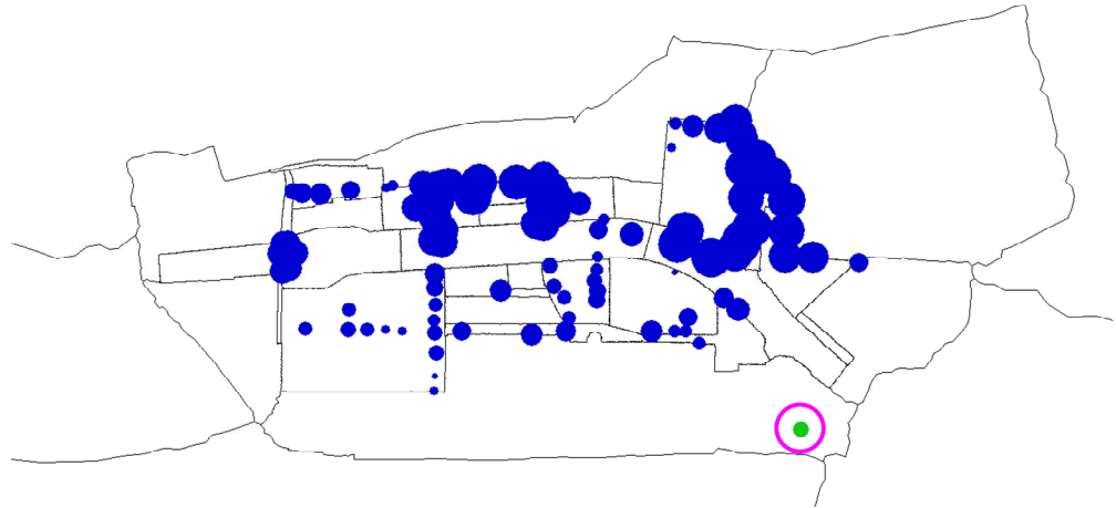
Figuur 17: resultaat gevoeligheidsanalyse c-waarde 50 %. Een blauwe stip geeft een grondwaterstand weer die lager ligt dan de geijkte grondwaterstand, een groene stip een grondwaterstand die hoger ligt dan de geijkte grondwaterstand. Rechtsonder is een groene stip in een paarse cirkel te zien. De doorsnede van deze groene stip geeft een afwijking van 20 cm weer.
