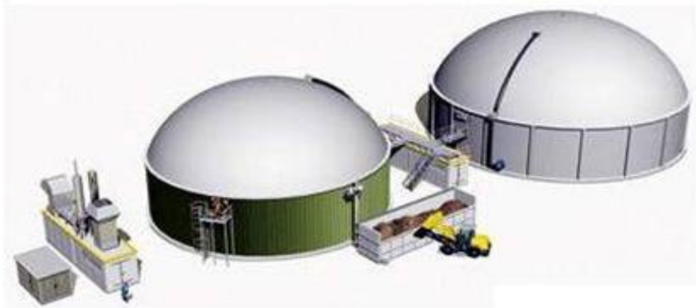
Figuur 9. Schematische weergave van een vergister, navergister, aanvoer van co-producten en technische ruimtes
