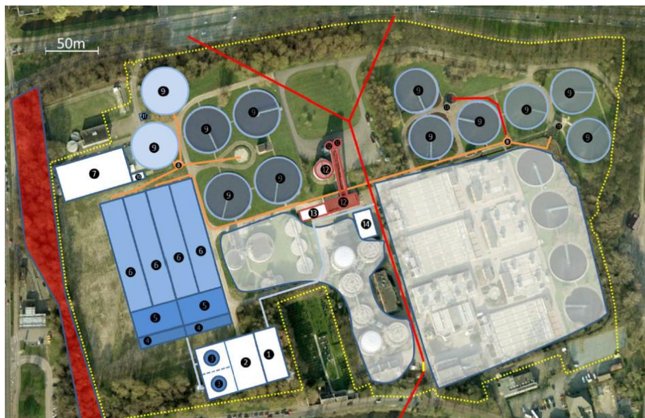
Figuur 6.9: Mogelijke lay-out nieuwe mUCT installatie
