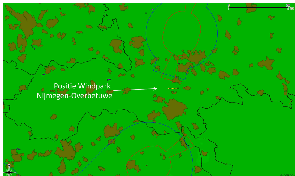
Figuur 6 Detectiekans van het MASS primaire verkeersleidingsradarnetwerk op 1000 voet boven het bouwplan nadat deze is gerealiseerd. De locaties van de windturbines zijn aangegeven met gele stippen. Op dit figuur is detectiekansmiddeling toegepast.
