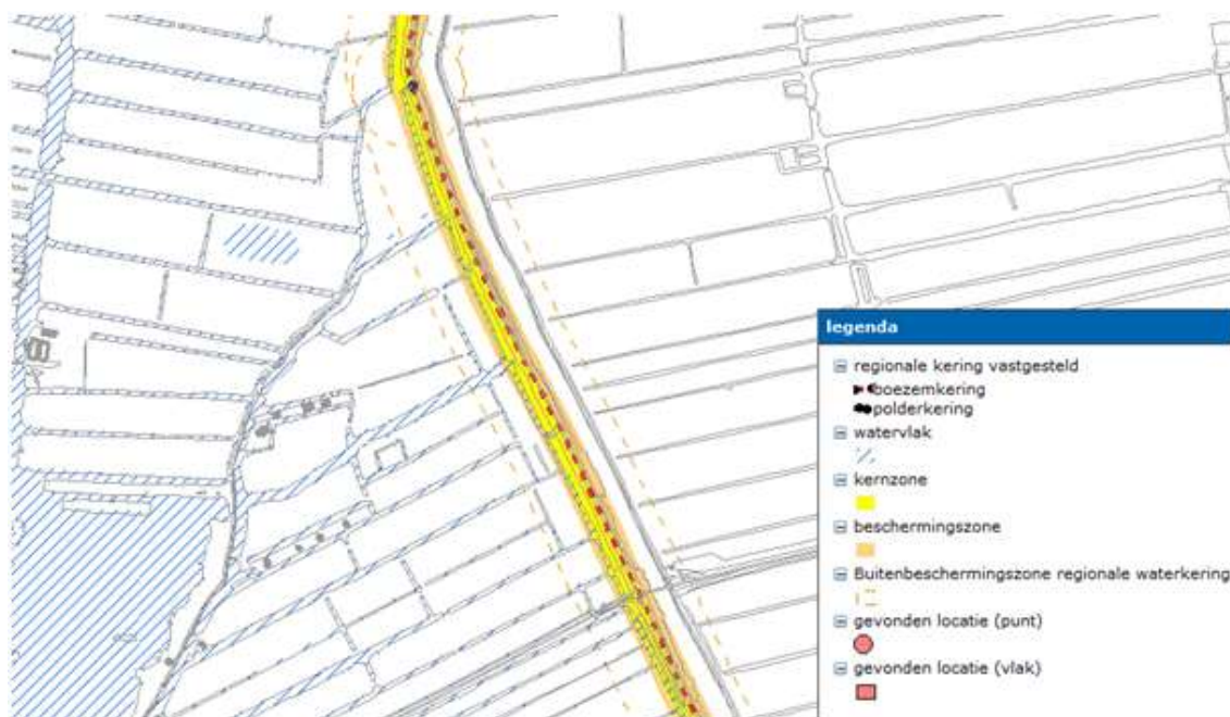
Figuur 4.18 Waterkering met kern- en beschermingszone ( http://rijnland.esri.nl/keringen/ )
