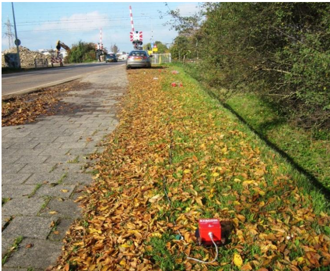
Figuur 4, Meetopstelling Limmelderweg (meting trillingen spoor).
