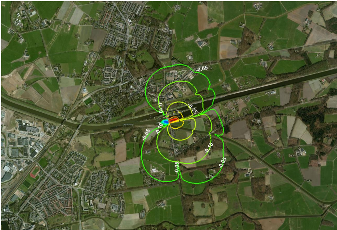
Figuur 7.3: Variant Midden-Noord: daling in freatisch pakket bij OLR peil in de IJssel en een GLG-grondwatersituatie (aanlegfase)
