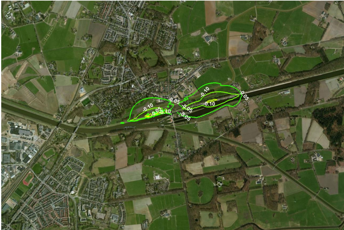
Figuur 6.5: Variant Noord: daling in freatisch pakket bij aanleg bij een T=10 peil in de IJssel en een GHG-grondwatersituatie (eindsituatie)
