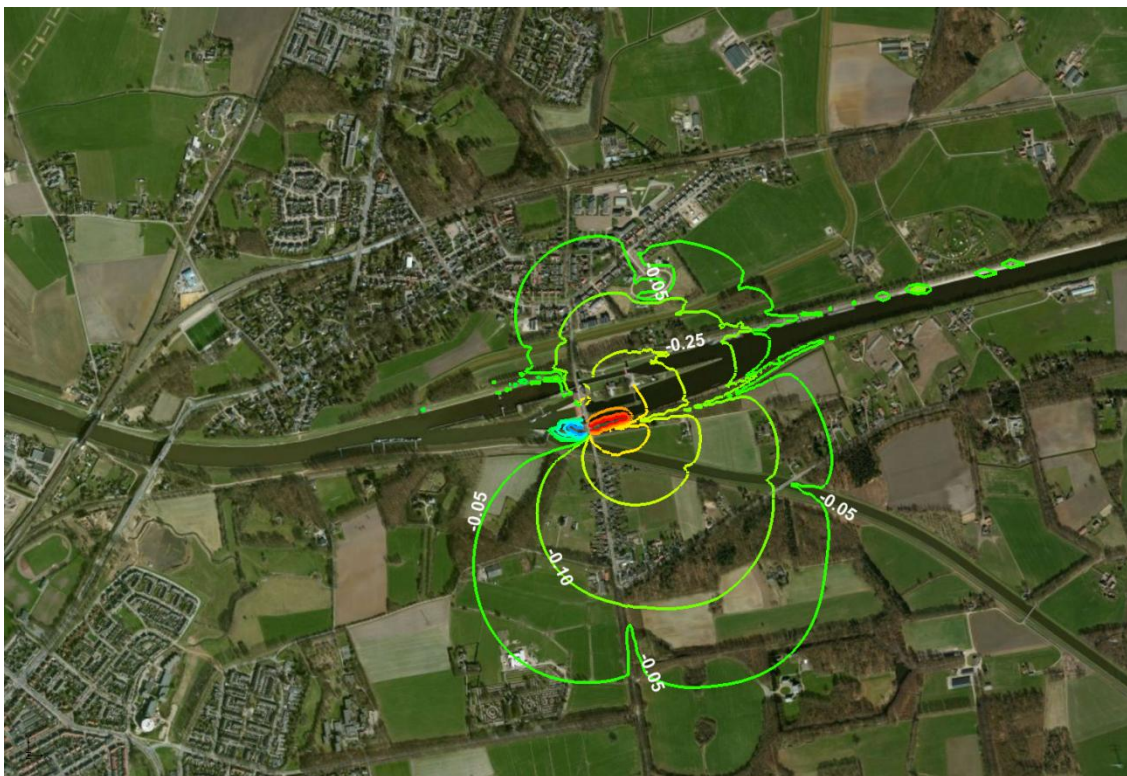
Figuur 7.1: Variant Midden-Noord: daling in freatisch pakket bij gemiddeld peil in de IJssel en een gemiddelde grondwatersituatie (aanlegfase)
