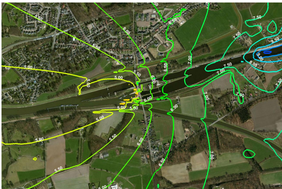
Figuur 4.1: Berekende stijghoogten in het bovenste deel van het watervoerend pakket bij een gemiddelde IJsselstand
