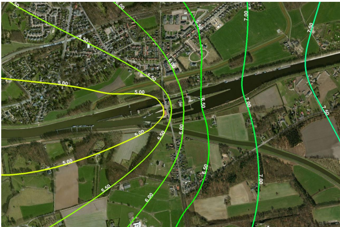
Figuur 4.2: Berekende stijghoogten in het onderste deel van het watervoerend pakket bij een gemiddelde IJsselstand
