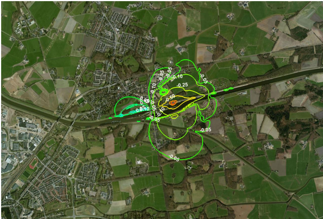
Figuur 6.8: Variant Noord: daling in freatisch pakket bij gemiddelde situatie waarbij circa 45 bij 50 m ontgraven is als mitigerende maatregel (in m)
