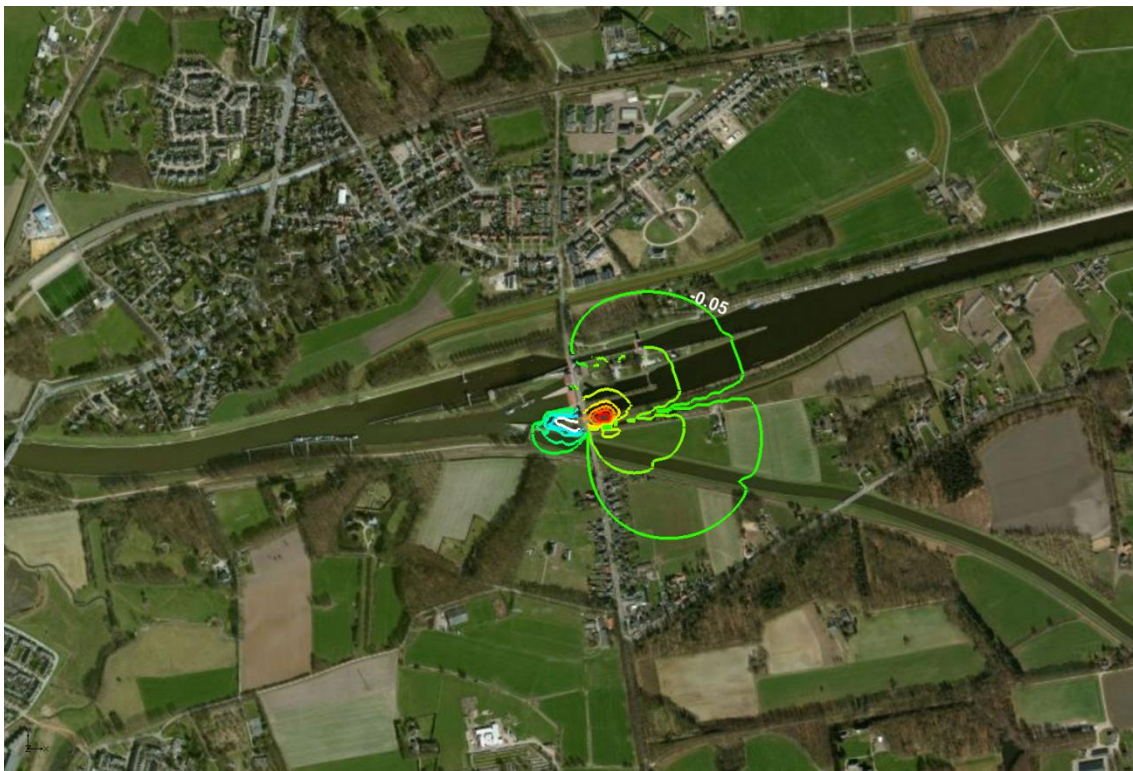
Figuur 7.5: Variant Midden-Noord: daling in freatisch pakket bij gemiddeld peil in de IJssel en een gemiddelde grondwatersituatie met mitigerende maatregel
