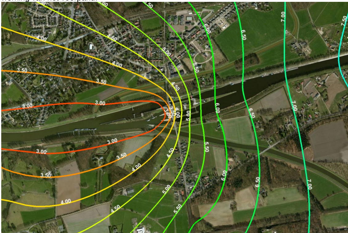
Figuur 4.4: Berekende stijghoogten in het watervoerend pakket bij ORL
