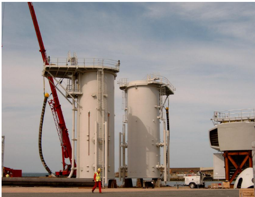
Figuur 3.1: Transitiestuk bij monopaal
