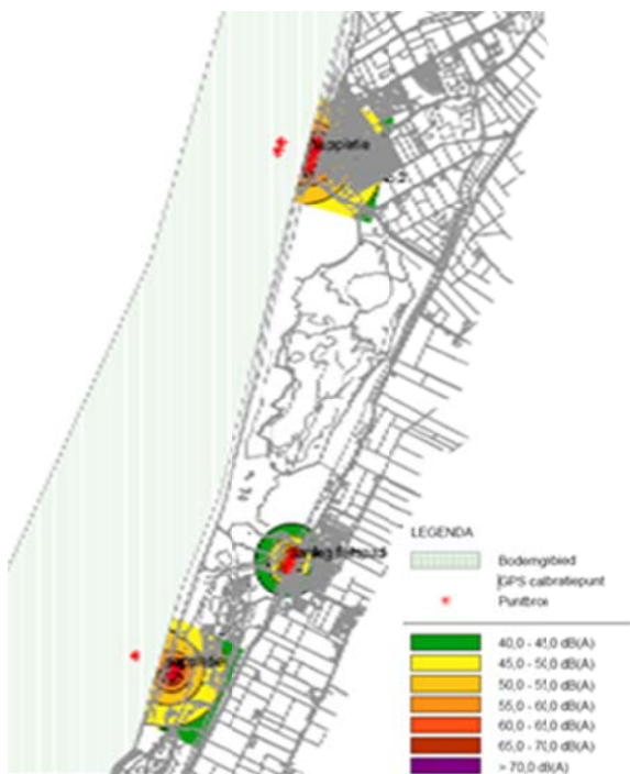
Afbeelding 94: Geluidscontouren etmaalwaarde alternatief 1 op 5 meter hoogte
