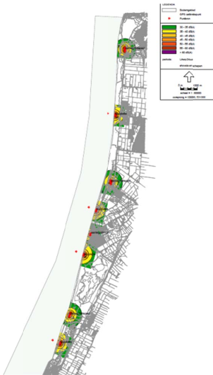
Afbeelding 96: Geluidscontouren etmaalwaarde alternatief 3 op 5 meter hoogte
