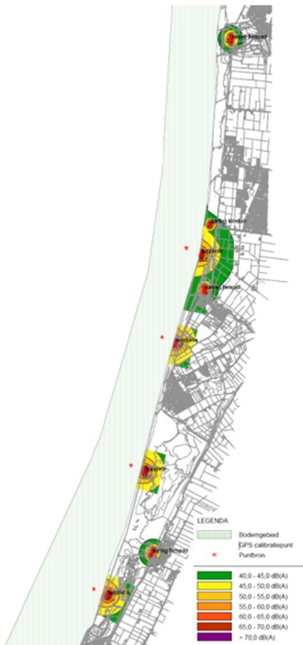
Afbeelding 95: Geluidscontouren etmaalwaarde alternatief 2 op 5 meter hoogte
