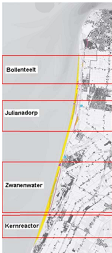
Afbeelding 68: De vier gebieden van de deelmodellen van het grondwatermodel opgezet voor de afweging van de alternatieven voor water
