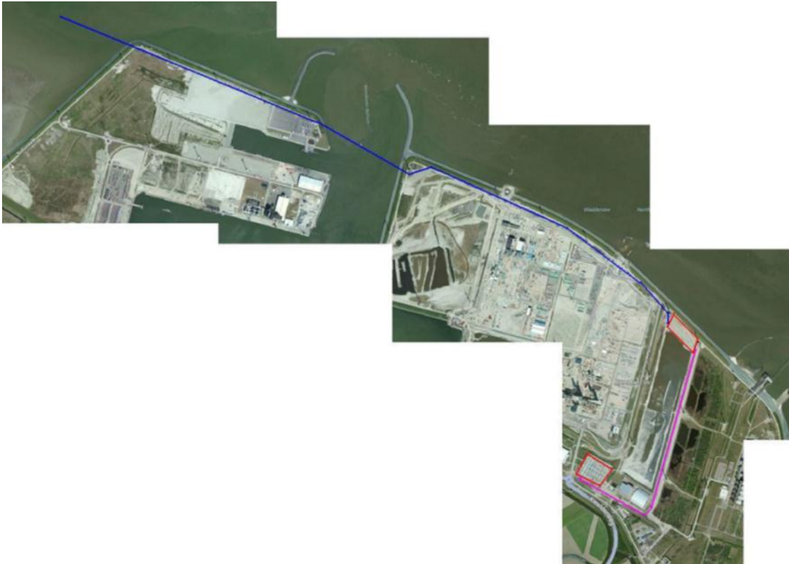
Figuur 17 Landtracé kabel (blauwe lijn = oostelijke aanlanding tot schakel- en transformatorstation; roze lijn = landtracé tot aansluiting openbaar elektriciteitsnet).
