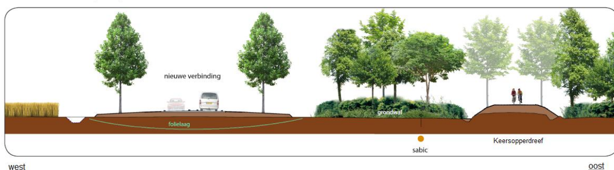
Figuur 6.3: Dwarsdoorsnede variant Aom (Ao-maaiveld) met folieconstructie en verhoogde ligging Keersopperdreef
