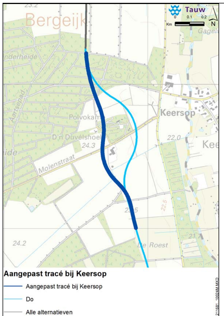
Figuur 9.13 Aangepast tracé Do bij Keersop
