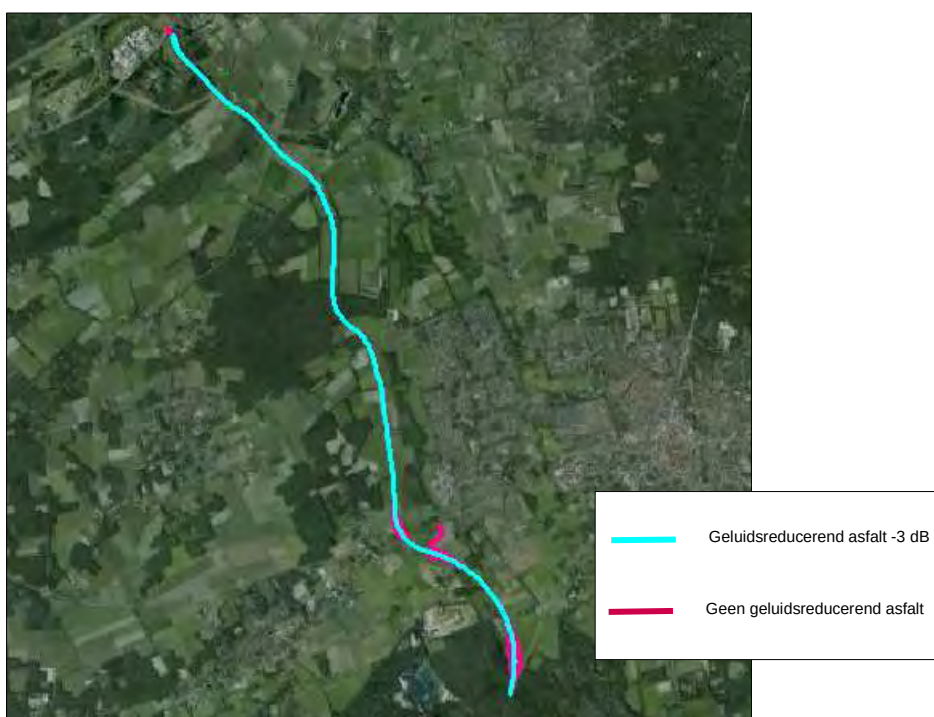
Figuur 3.1: Overzicht van het toegepaste geluidsreducerend asfalt op de Westparallel
