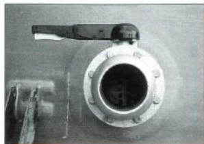
Kunststof vlinderklep met 6" tankwagenkoppeling
