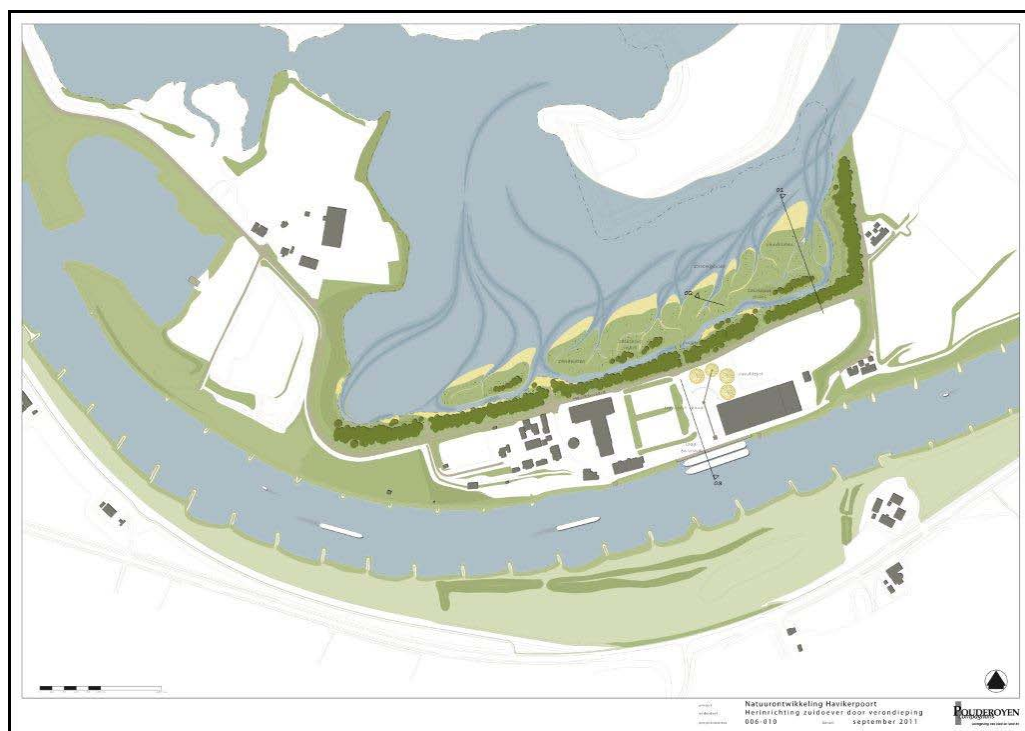
Figuur 1.2 Bovenaanzicht van het eindresultaat van de ingreep. Streep-punt-lijn = oorspronkelijke oever, geel = zandwallen. De aanleg van de geul in het noordoosten (rechtsboven in de figuur) is geen onderdeel van de ingreep die in dit rapport wordt getoetst.
