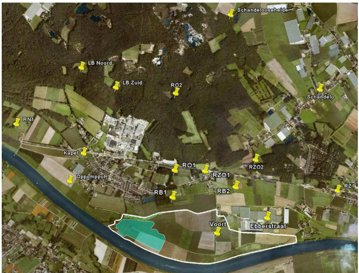
Figuur 4.1. Dagelijks waargenomen peilbuizen van het monitoring systeem, aanduiding volgens DCM. De overeenkomst met figuur 3.1 is als volgt: Oppompput is Retourbemaling, Kapel is 52GP0264, RB1 is BD1, RZ01 is bij meetdoel B3, RB2 is BD2, Voort is 52GP0824, Ebberstraat is 52GP0826, Schandelo is 52HB0007, Schandeloose Heide is 52HP0104. RZ02 ligt meer westelijk dan op figuur 3.1 was gepland.
