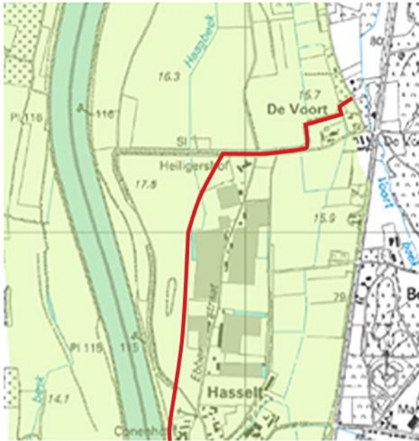
Figuur 3.2 Ligging van de bestaande kade na de verlegging in het voorjaar van 2012 (rode lijn)
