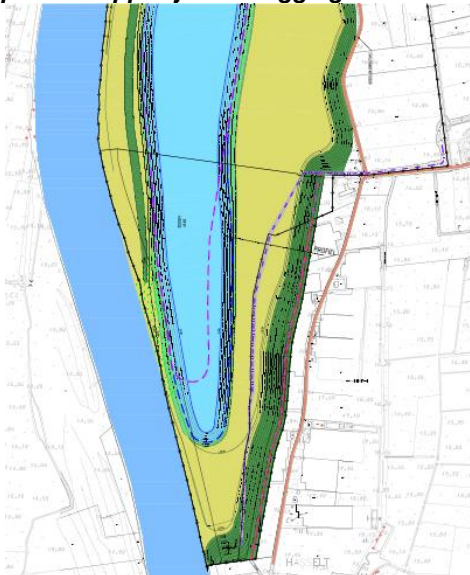
Figuur 6.6 De zuidkant van de hoogwatergeul in de eindsituatie bij alternatief 2. Met de paarse stippellijn is de ligging van de hoogwatergeul weergegeven voor alternatief 1.
