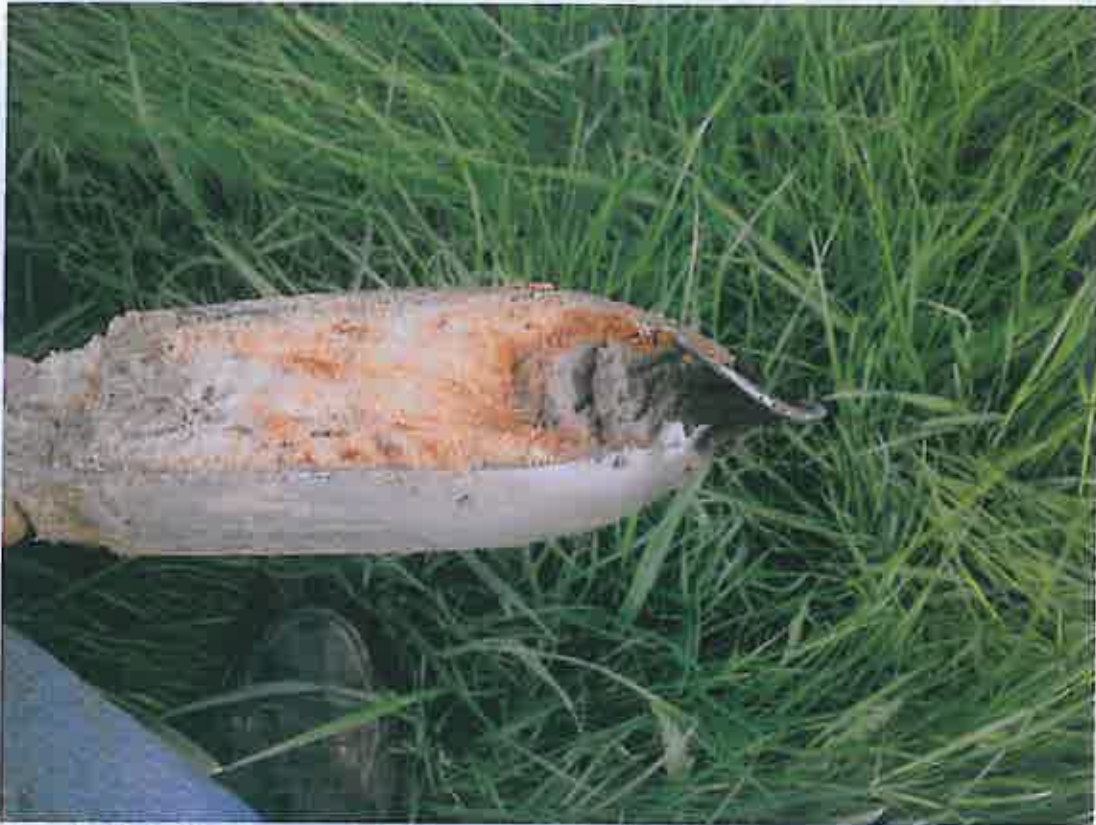
Figuur 10. Boring 39 met een zandpakket bovenop een dun siltlaagje en vervolgens venige afzettingen (in de punt van de boor):
