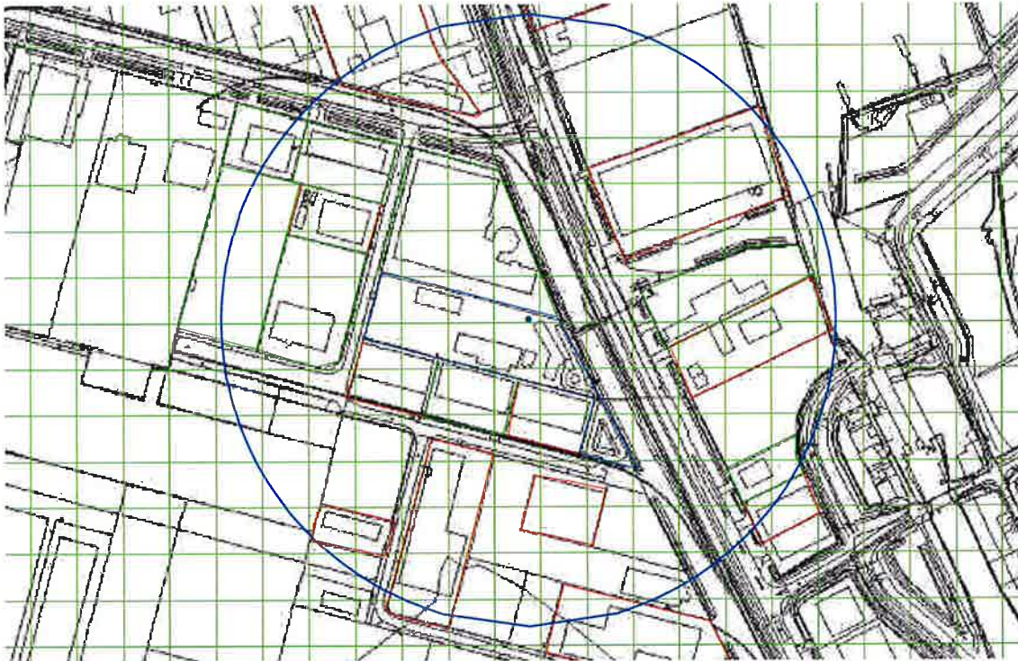
Figuur 3: effectafstand 1%-letaliteit (de blauwe contour) De afstand tussen de grids bedraagt 50 meter.
