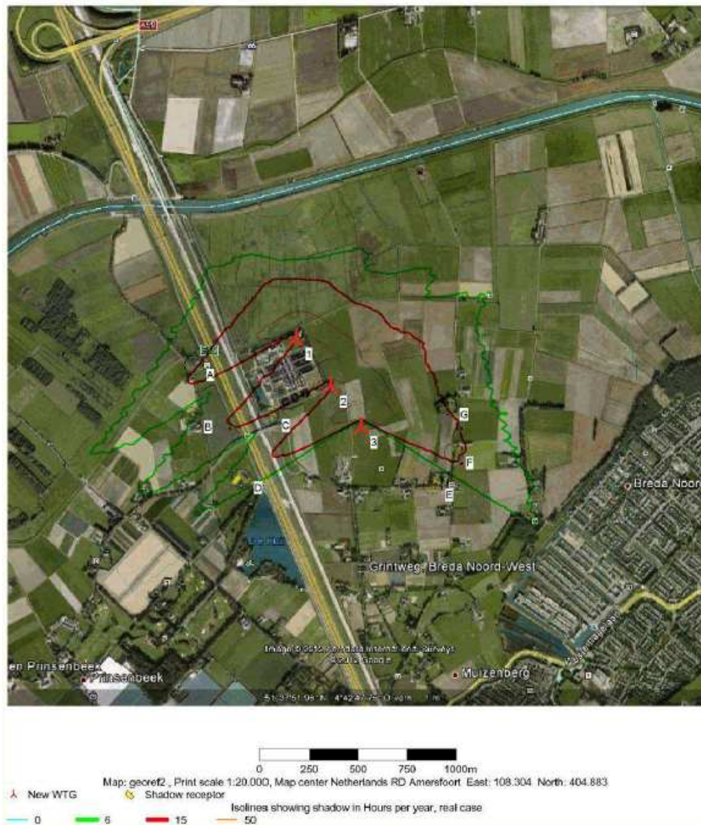
Figuur 5.10 Contouren slagschaduw Nordex [LBP Sight, 2012]
