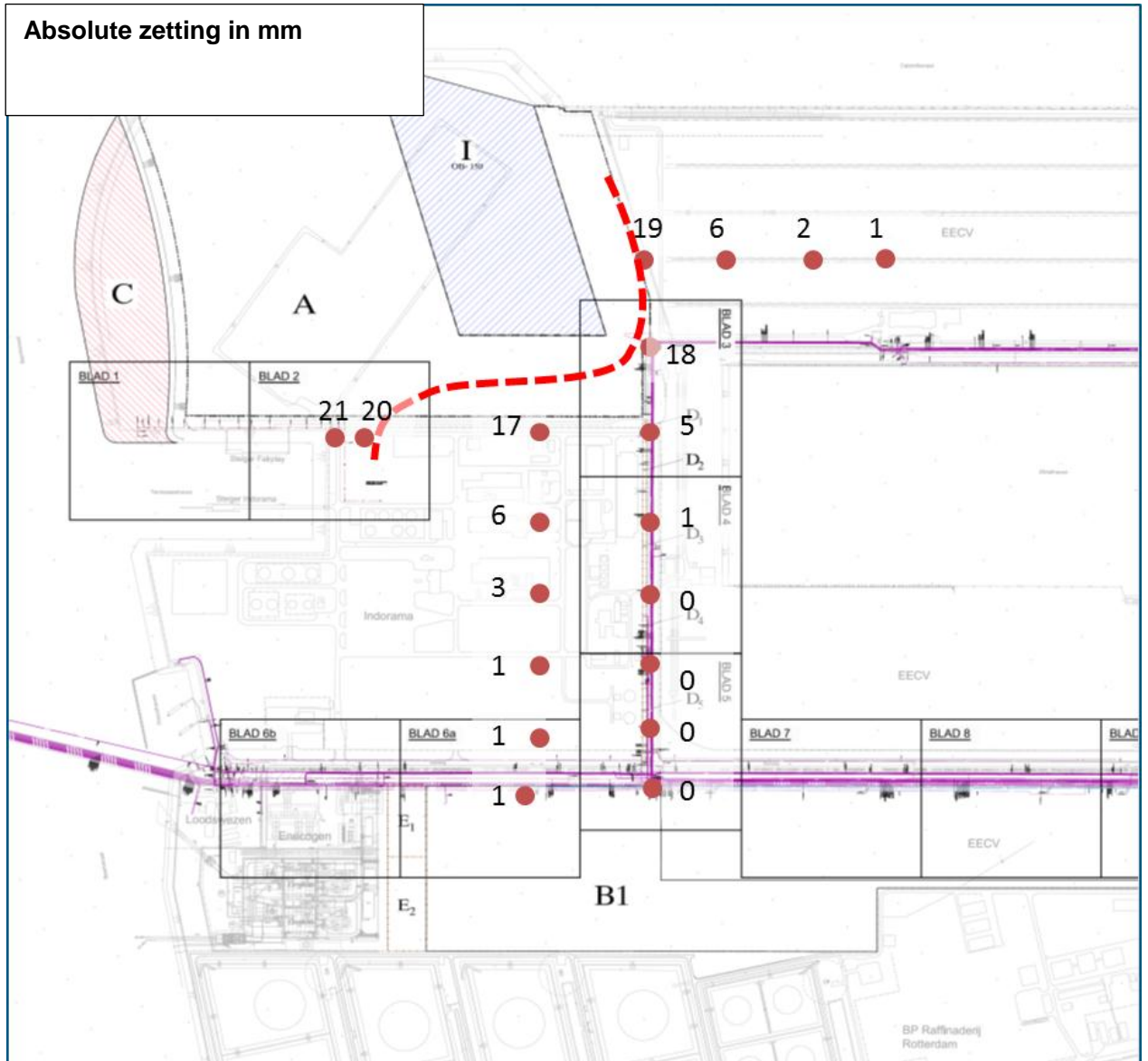
Afbeelding B8.3. Berekende absolute zettingen in mm nabij gevoelige objecten. Ten noord-westen van de rode stippellijn zijn de absolute zettingen >20mm.
