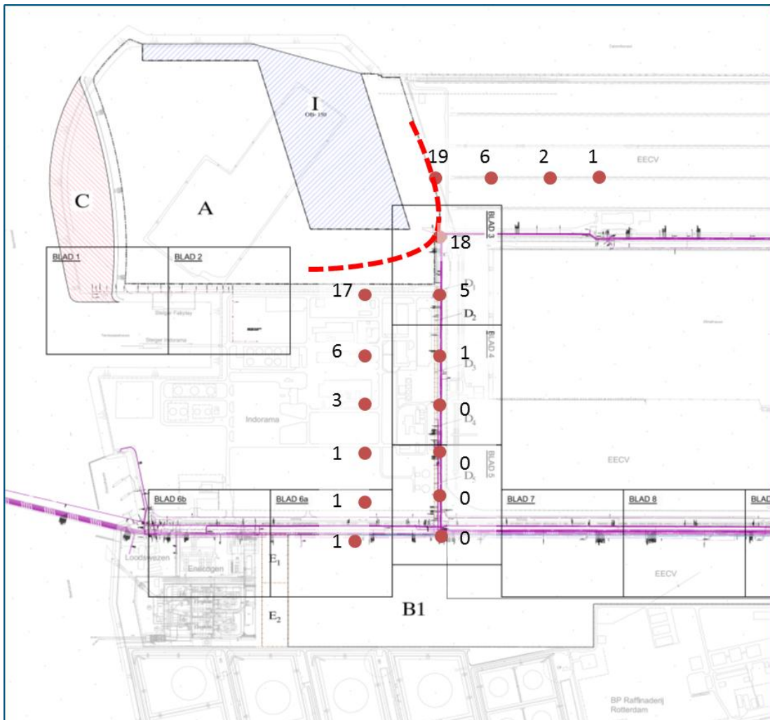
Figuur 13.4 Berekende absolute zettingen in mm nabij gevoelige objecten als gevolg van constructie zeekeade. Ten noord-westen van de rode stippellijn zijn de absolute zettingen >20mm.
