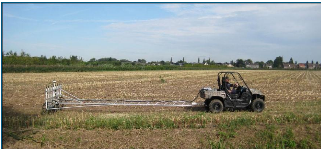
Figuur 13.1 Multisensorsysteem ten behoeve van opsporing van niet-gesprongen explosieven, door een voertuig voortgetrokken [23]
