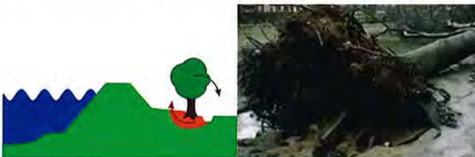
Afbeelding 7: Schematische weergave windworp als faalmechanisme (l) en een voorbeeld uit de praktijk (r)
