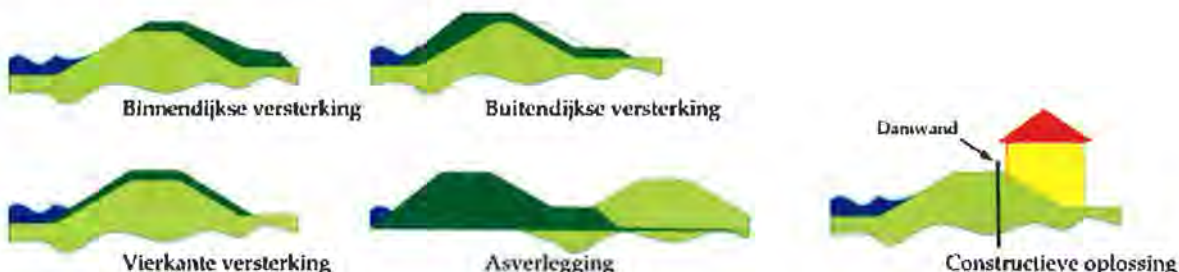
Afbeelding 14: Principe-oplossingen voor de dijkversterking
