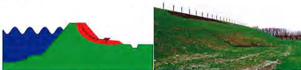
Afbeelding 4: Schematische weergave binnenwaartse macrostabiliteit als faalmechanisme (l) en een voorbeeld uit de praktijk (r)
