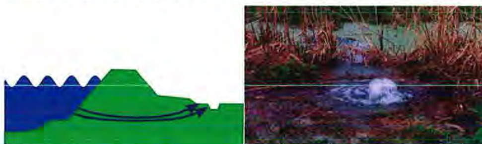
Afbeelding 5: Schematische weergave piping als faalmechanisme (l) en een voorbeeld uit de praktijk (r)
