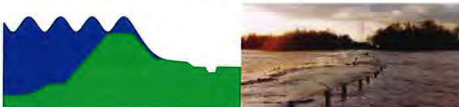
Afbeelding 6: Schematische weergave golfploop en -overslag als faalmechanisme (l) en een praktijkvoorbeeld (r)
