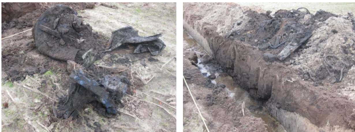
Figuur 6-8: Foto's stortmateriaal in voormalige sloot.
