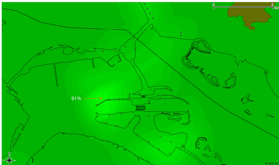
Figuur 17 Detectiekans van het MASS primaire verkeersleidingsradarnetwerk op 1500 voet boven en in de nabijheid van het bouwplan nadat deze is gerealiseerd. Op dit figuur is detectiekansmiddeling toegepast.
