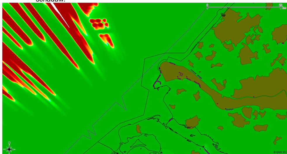
Figuur 12 Detectiekans van het MASS verkeersleidingsradarnetwerk berekend op 1500 voet in het schaduwgebied van het bouwplan nadat deze is gerealiseerd. Op dit figuur is detectiekansmiddeling toegepast. De ellips geeft de locatie aan van de schaduw.
