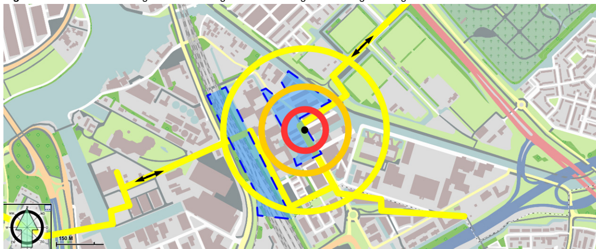
Figuur 4. Schematische weergave van een ongeval met een hoge druk aardgasleiding
