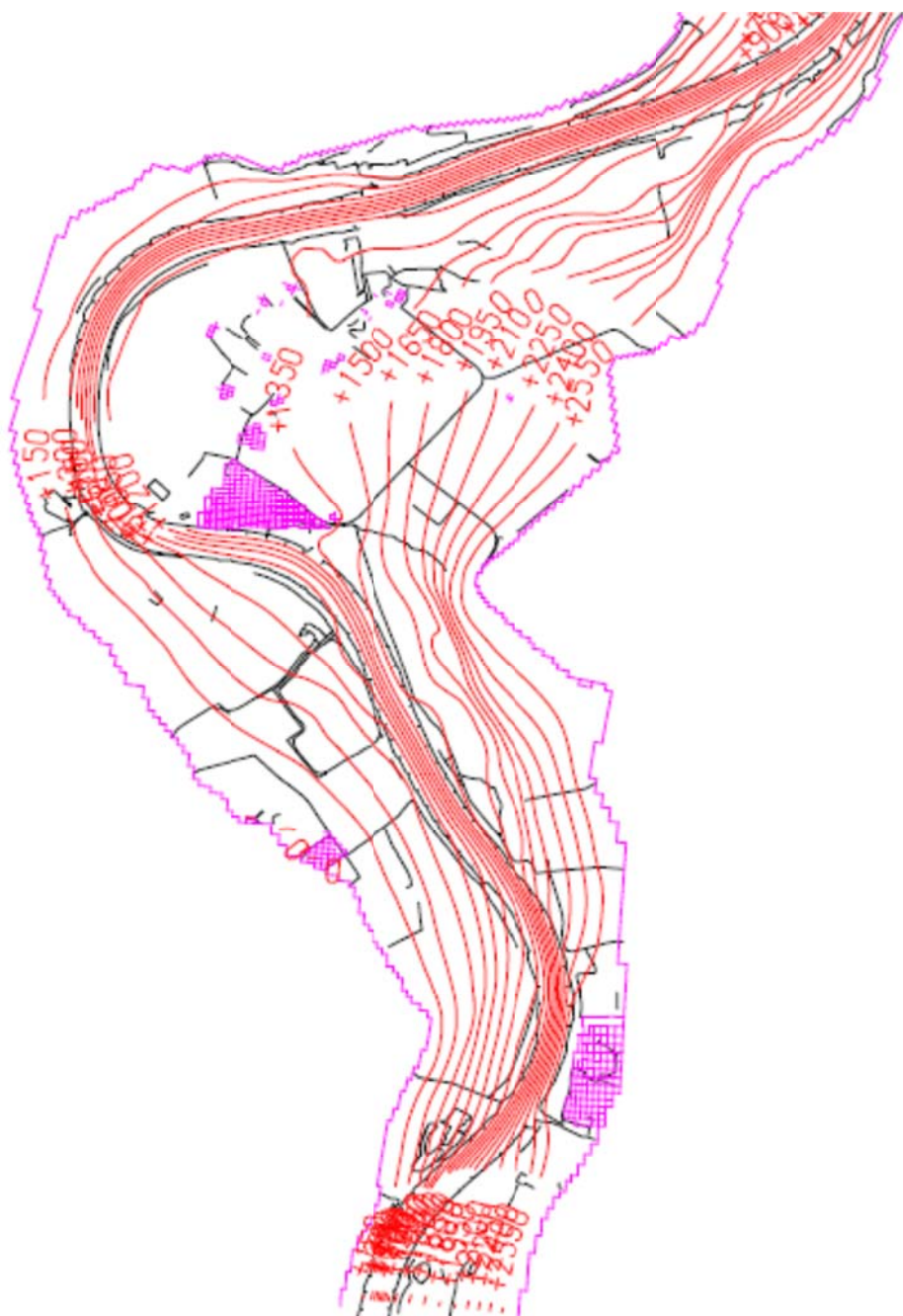
Figuur A.1: Stroomlijnen per 150 m 3 /s bij 16.000 m 3 /s te Lobith voor de huidige situatie
