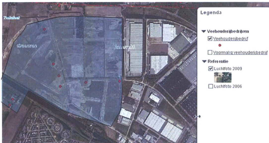
Figuur 5.4: Situatie na het bouwrijp maken van Vossenberg West II (met blauw is het plangebied aangegeven en de acht rode stippen (veehouderijen) in dit plangebied zijn meegenomen bij de berekeningen)
