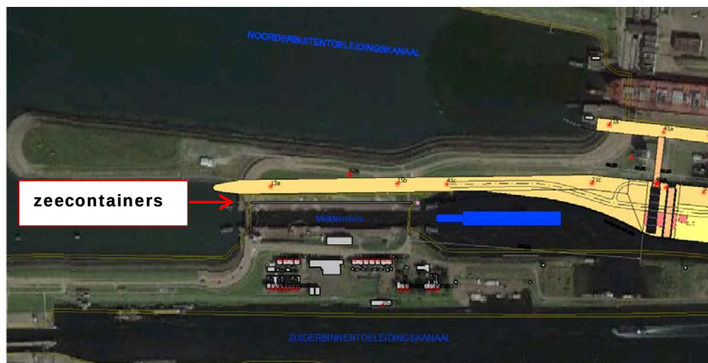
Figuur 3 – Locatie geluidafscherming door containers bij fuikwand
