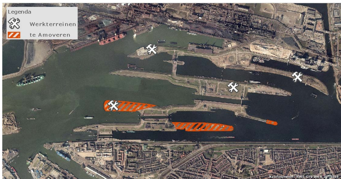
Figuur 4.3: Ligging werkterreinen en te verwijderen sluseilanden.
