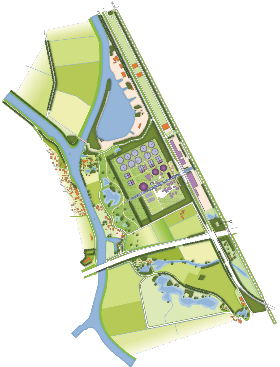
Figuur 5.3: De verwachte inrichting van de RWZI na renovatie in het conventioneel alternatief met ten westen daarvan de ecologische verbindingszone.
