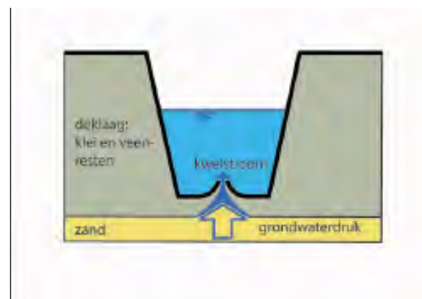
Figuur 4: Opbarsten van de slootbodem als gevolg van de hoge grondwaterdruk
