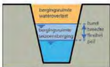
Figuur 11: Principe flexibel peilbeheer
