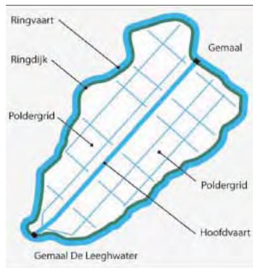
Figuur 1: De hoofdstructuur van de droogmakerij: ringvaart, ringdijk, rechthoekig stelsel van tochten, hoofdvlaart en gemalen
