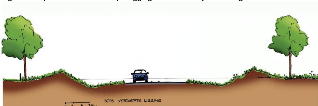
Figuur 3.12: profiel met iets verdiepte ligging van de westelijke rondweg
