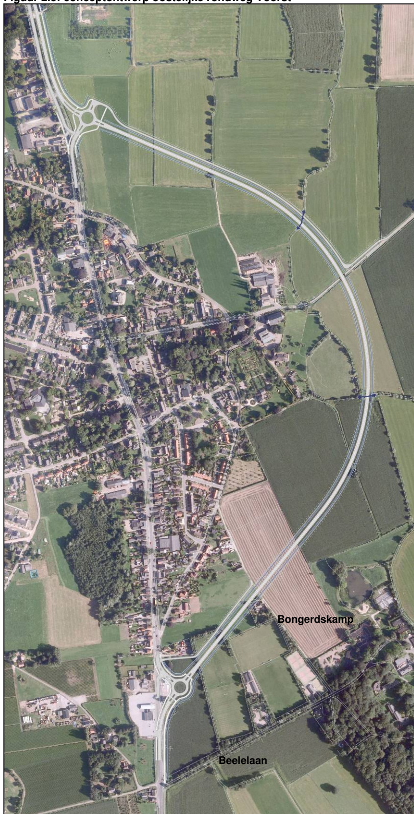
Figuur 2.3: conceptontwerp oostelijke rondweg Voorst
